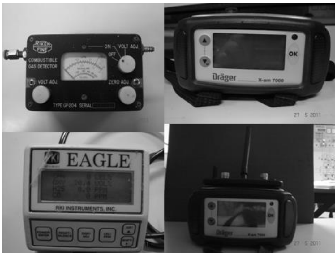
図7 (A) ガス監視装置
