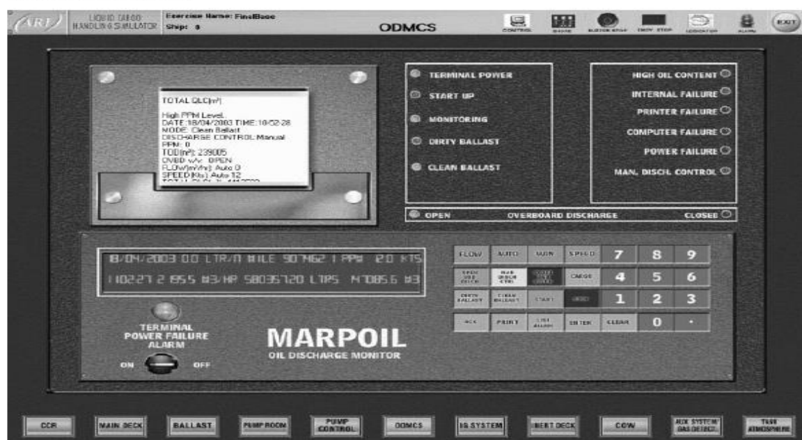
図 1 (T) オイル監視・制御システム (ODMCS) のパネルの配置図（記注：Oil date は不可解。通常は Oil discharge）
