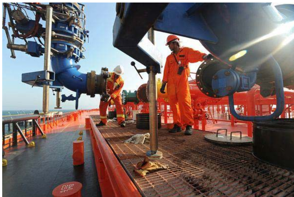
図 5 (B) 船舶／陸上積込みアームとマニホールドの接続
