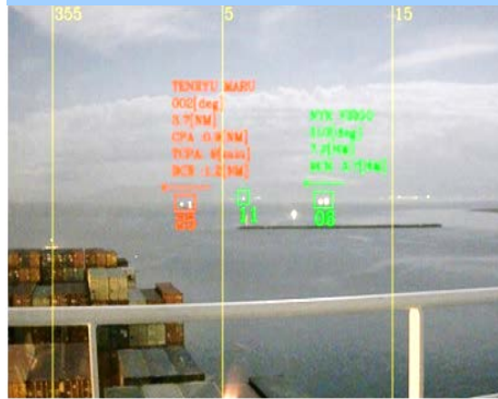
濃霧中における高感度カメラ画像による検出
