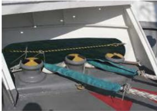
ビット・ボラード等の接触部にカバーをする
